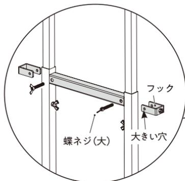
フックの穴の大きい方に蝶ネジ(大)を入れ、ねじ込んで止めます(2箇所)。
