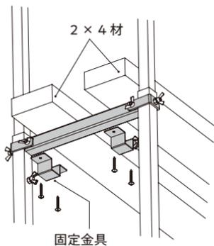
固定金具とタッピングネジで2×4材を下から固定します(2箇所)。
